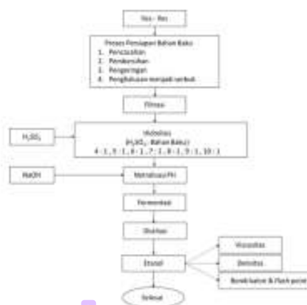
Gambar 3.1. Skema Proses Pembuatan Bioetanol dari Iles – Iles
