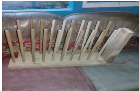
Gambar 1.6 Stik dimasukkan kedalam lubang kayu
