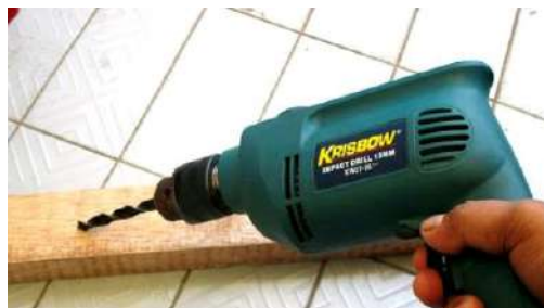
Gambar 1.5 kayu dilubangi dengan bor
