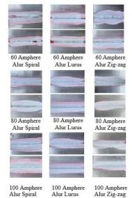
Hasil uji cacat pengelasan pada bagian weld metal dan root hasil pengelasan TIG dengan variasi parameter kuat arus pengelasan 60 ampere dengan penggunaan alur pengelasan spiral menunjukan menunjukan Indikasi cacat pengelasan terjadi atau adanya discontinuity berupa gas pore dengan ukuran R1 sebesar 0,2
