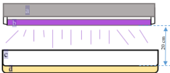
Gambar 1. Rancangan bangun fotooksidator UV 254nm.
