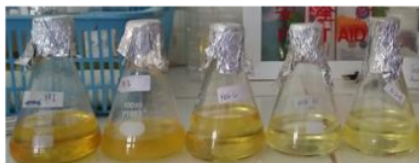
Gambar 2. Minyak Kontrol Hasil Fotooksidasi Sinar UV 254nm. (Kanan ke kiri: Perlakuan 1, 6, 12, 24 jam paparan sinar UV 254nm)
