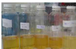
Gambar 3. Minyak TBHQ Hasil Fotooksidasi Sinar UV 254nm. (Kanan ke kiri: Perlakuan 1, 6, 12, 24 jam paparan sinar UV 254nm)
