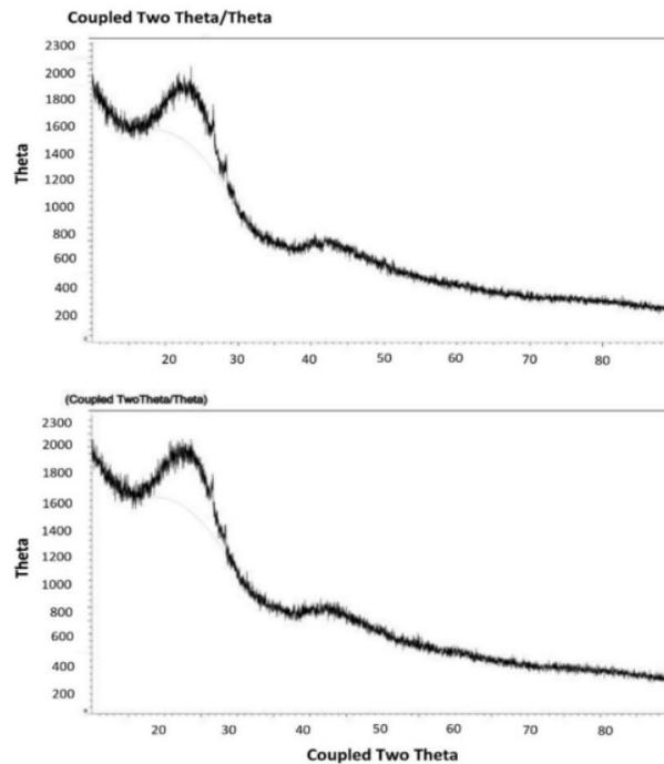
**Gambar 1.** Hasil XRD. (a) karbon kulit salak dengan aktivator bertingkat Karbon  $ZnCl_2 + KOH$ (s) (b) karbon kulit salak dengan aktivator bertingkat Karbon KOH +  $ZnCl_2$  (s)
